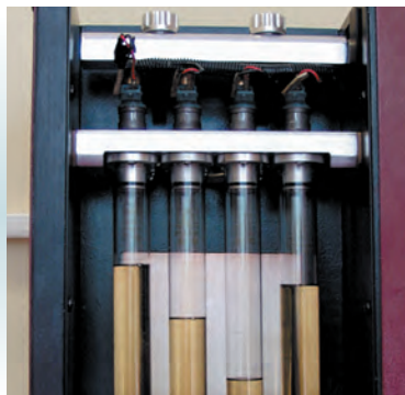
Рис. 2 Неравномерность работы форсунок двигателя VAZ-2111 с пробегом 18 000 км, вызванная загрязнениями
