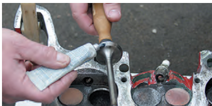
Притирка клапанов «Абразивной пастой для шлифования металлов»
