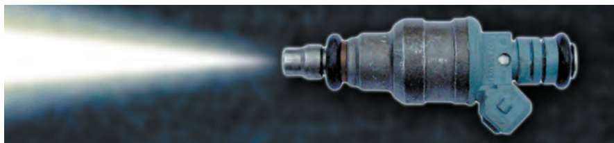
Факел распыла после использования очистителя
