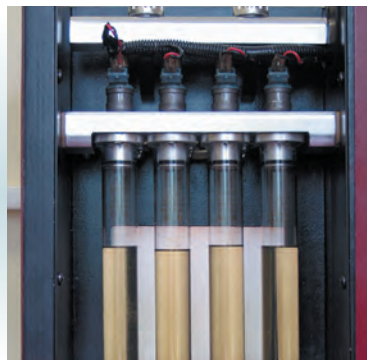
Рис. 3 Те же форсунки после применения моющих присадок Hi-Gear
