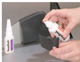
Рис. 1. При использовании обычных цианакрилатных клеев адгезив и активатор наносятся на разные поверхности
