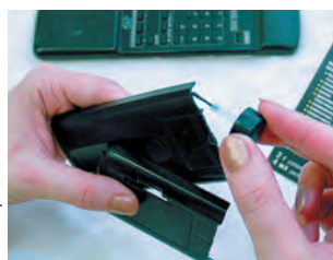
Рис. 2. При использовании цианакрилатного суперадгезива для пластика адгезив и активатор наносятся на одну и ту же поверхность
